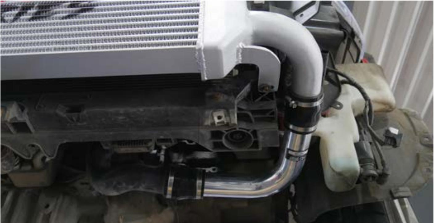
9. Auf der anderen Seite montieren Sie nun auch die mitgelieferten Silikonschläuche und das Alurohr mit dem Ladeluftkühler, sowie dem originalen Druckrohr.
