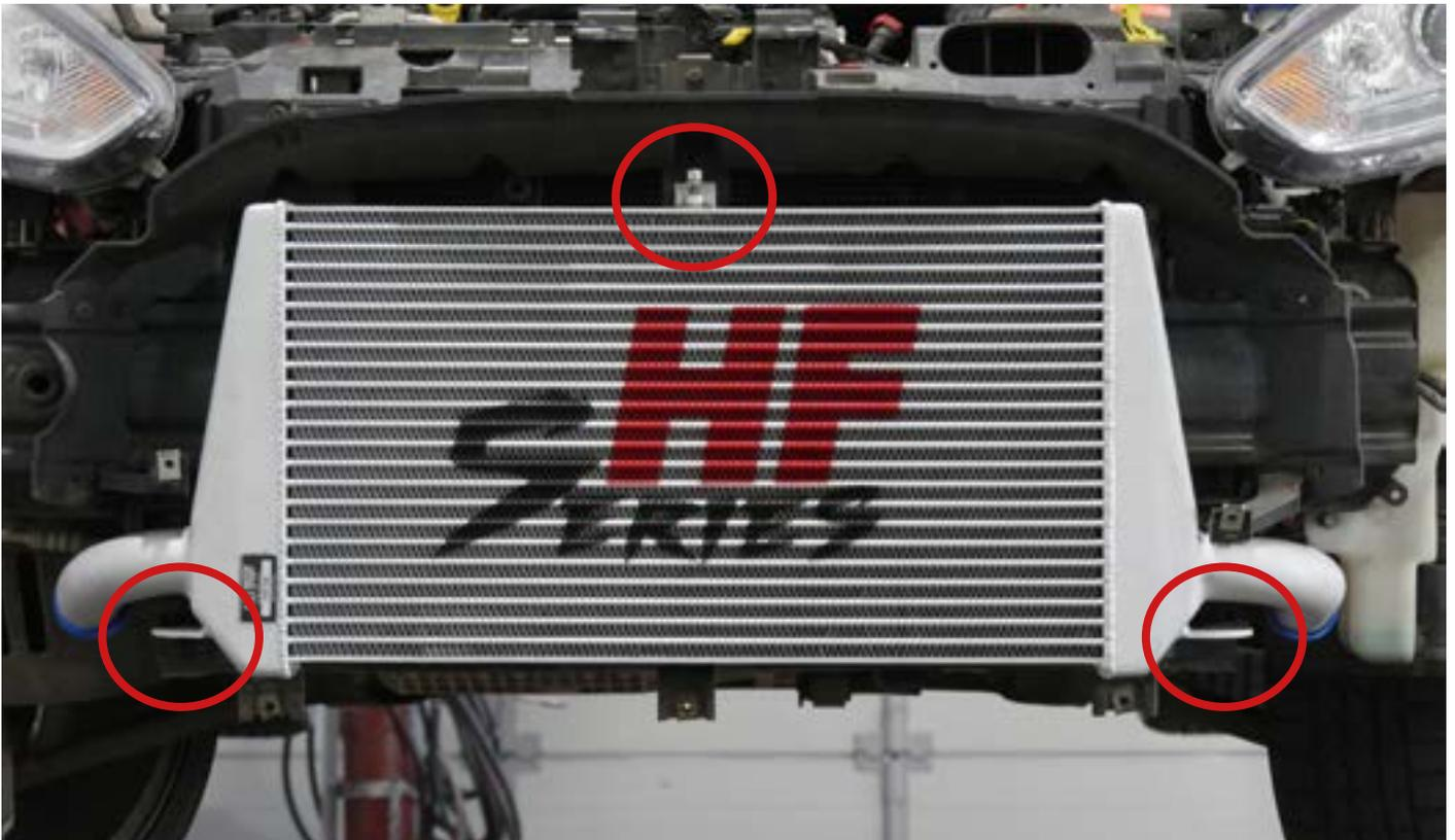
(Bauartbedingt kann es notwendig sein, den oberen Halter etwas in Richtung Stoßfänger zu biegen)
