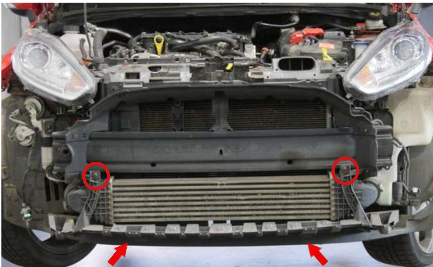
4. Lösen Sie nun bitte die Schelle zum Ladeluftschlauch mithilfe einer 7mm Nuss. Demontieren Sie nun die beiden Befestigungsschrauben des Ladeluftkühlers mit dem 10mm Steckaufsatz.
