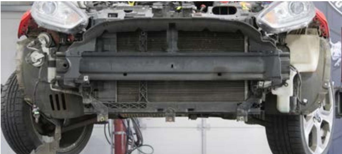
6. Montieren Sie den mitgelieferten Halter, mit der kleineren Bohrung in Richtung des Schlossträgers.
