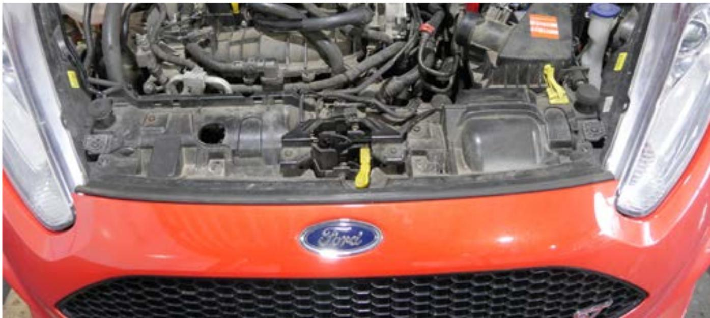
3. Demontieren Sie mit dem 10mm Steckaufsatz den unteren Stoßfängerträger
