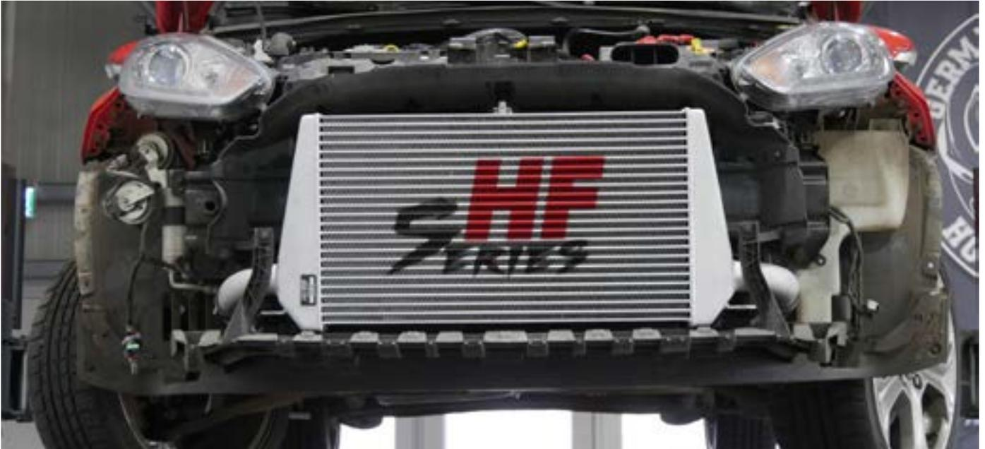
11. Je nach Spaltmaßausrichtung des Fahrzeuges, kann es im Einzelfall notwendig sein, den Stoßfänger in dem markierten Bereich, mit Werkstattmitteln an der Innenseite in Richtung des Ladeluftkühlers anzupassen.
