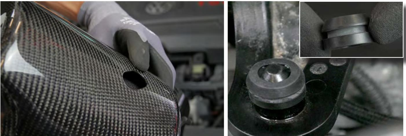
15. Stecken Sie die neue Dichtung auf die originale Haltebuchse (aus Punkt 9) - diese passt später in das Loch auf der Unterseite des Luftfilterkastens.
