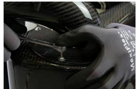
13. Nun können Sie den Luftfilter mit dem Luftfilterkasten
