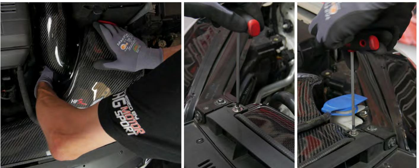
17. Nun können Sie die Ansaugung fixieren. Dazu drücken Sie den Luftfilterkasten auf die Haltebuchse und verschrauben das System an den beiden vorderen Haltepunkten.
