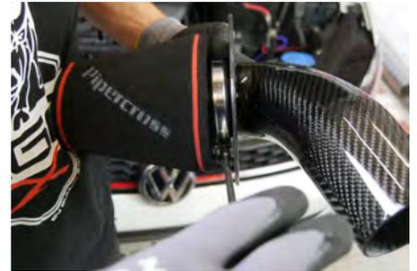
10. Stecken Sie nun den Pipercross Luftfilter auf das neue Carbon-Ansaugrohr und ziehen Sie die Schelle fest.
