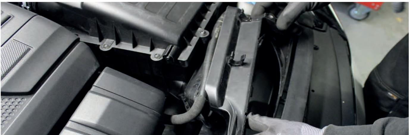
5. Lösen Sie die beiden Torx-Schrauben (T25), mit denen der Luftsammler befestigt ist. Diese befinden sich auf der linken und rechten Seite des Luftsammlers.
