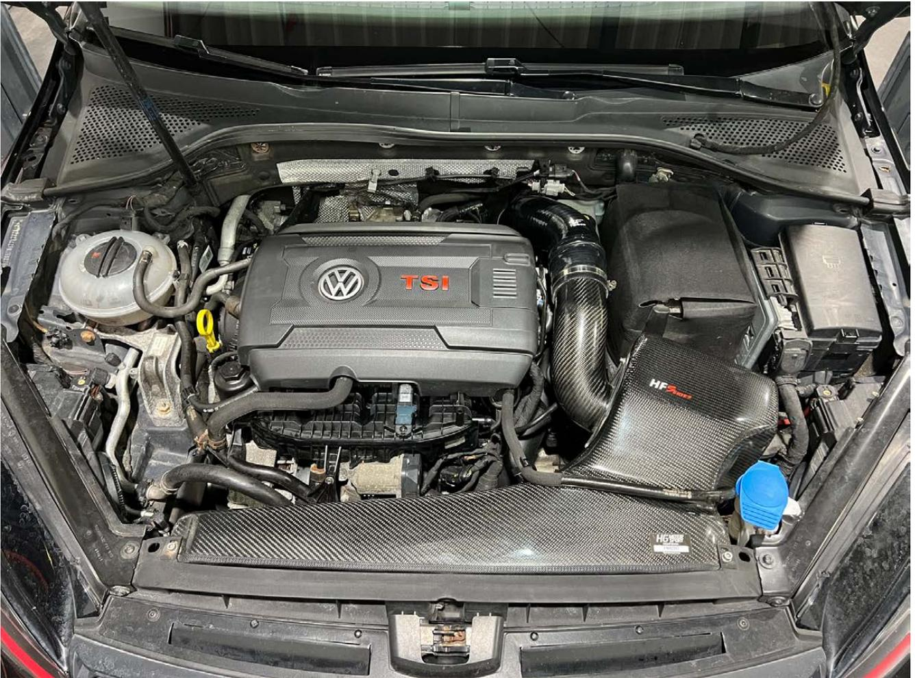
20. So sollte das Ansaugsystem nach dem Einbau optimaler Weise aussehen.
