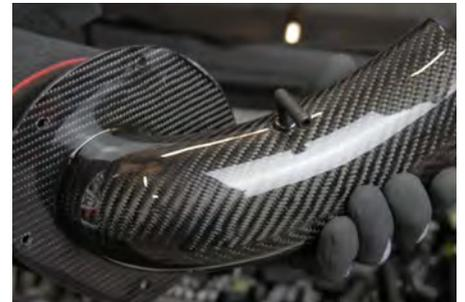
11. Um den Druckanschluss zu installieren, verbauen Sie zuerst die Dichtung und stecken danach den Winkelanschluss hinein.
