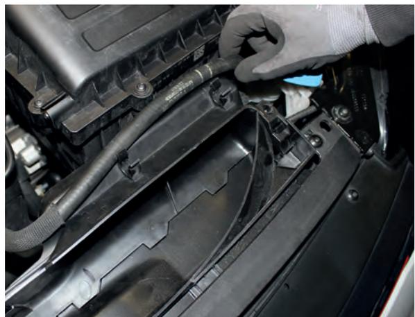
4. Lösen Sie die beiden Kunststofffixierungen an der linken und rechten Seite des Luftsammlers leicht und ziehen Sie sie dann mit einer leichten Linksdrehung aus dem Luftsammler heraus.
