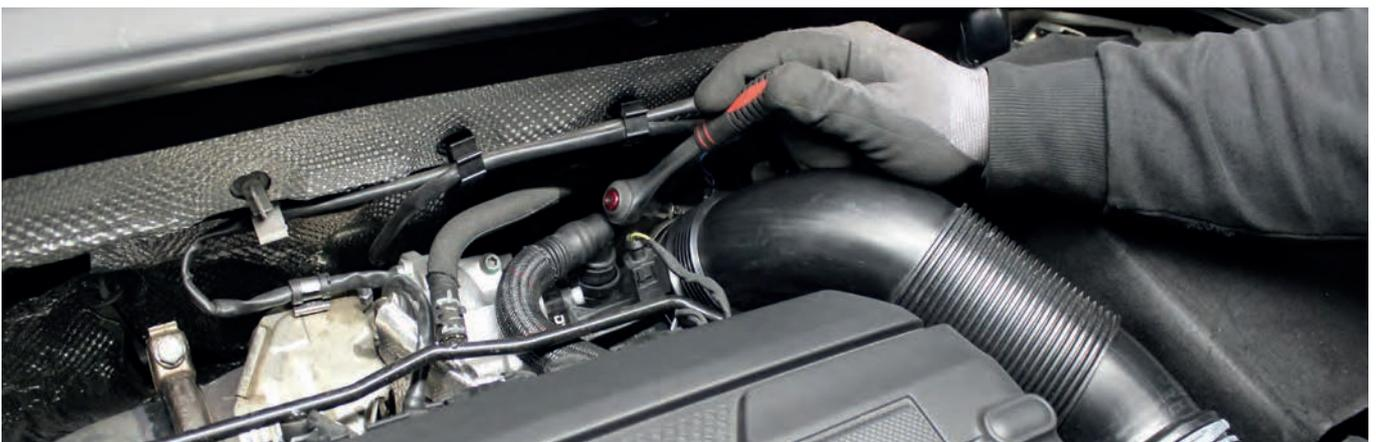
8. Entfernen Sie den Unterdruckschlauch, der sich an der Seite des Luftfilterkastens befindet, indem Sie einfach den entsprechenden Anschluss abziehen.
