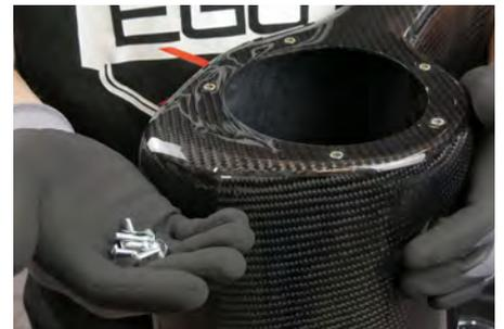
12. Entfernen Sie nun alle Schrauben aus dem Luftfilterkasten.
