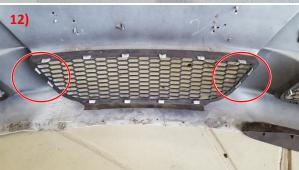
Überprüfen Sie alle Teile auf korrekten Sitz und montieren Sie die Stoßstange und den Unterboden wieder am Fahrzeug.
